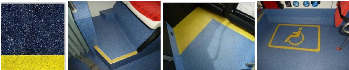
Figura 8.- Señalización esquinas y escalones
