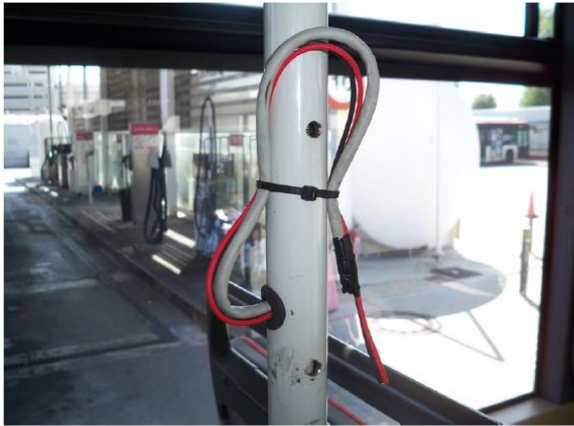
Imagen 15. Agujero de salida cables validadora.
