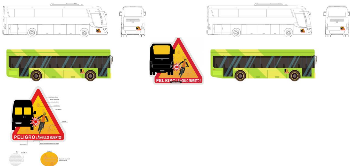
Figura 21.- Señalización ángulo muerto. Conforme a instrucción VEH 21/05.
