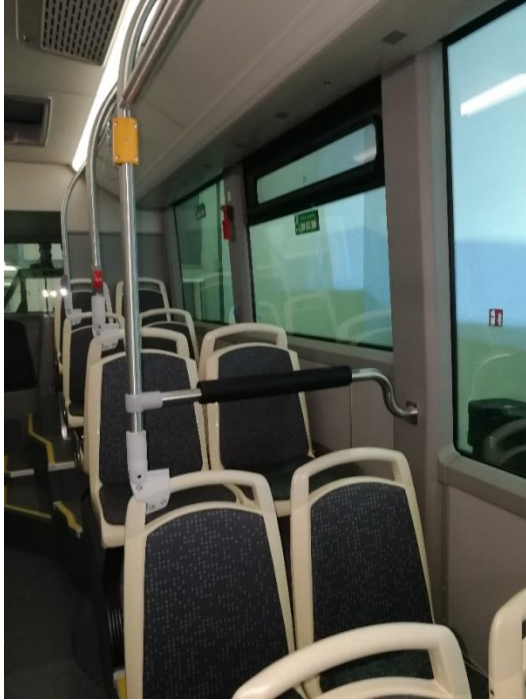
Figura 23.- Barra de protección para que en el caso de desaceleración brusca y su protección
