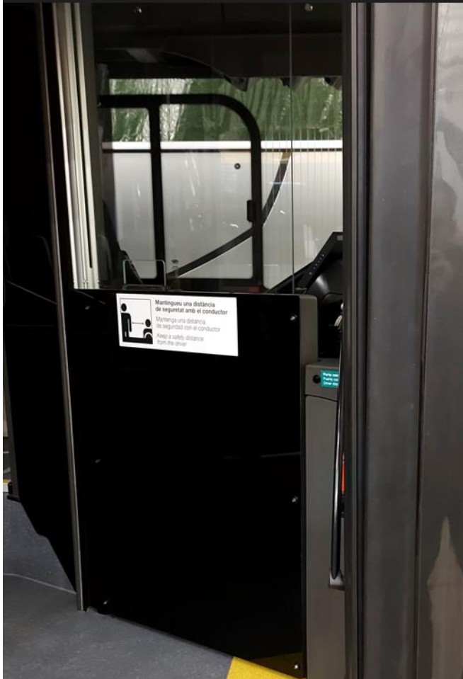
Fig 34, Mampara retráctil del habitáculo del conductor, cumple Reglamento 43, tiene contraseña de homologación y monta un sistema de seguridad anti-atrapamiento. Se recoge en la puerta del habitáculo
