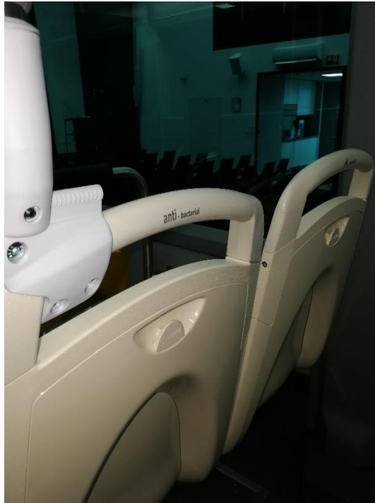
Figura 33. Anclaje barra en el respaldo del asiento
