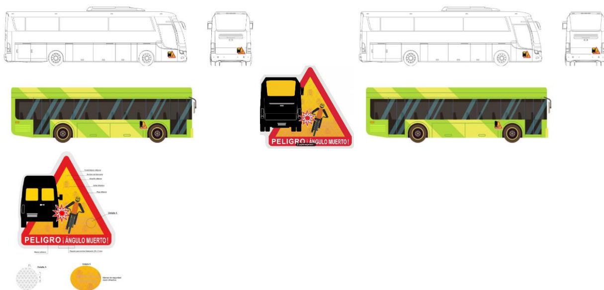
Figura 22.- Señalización ángulo muerto. Conforme a instrucción VEH 21/05.
