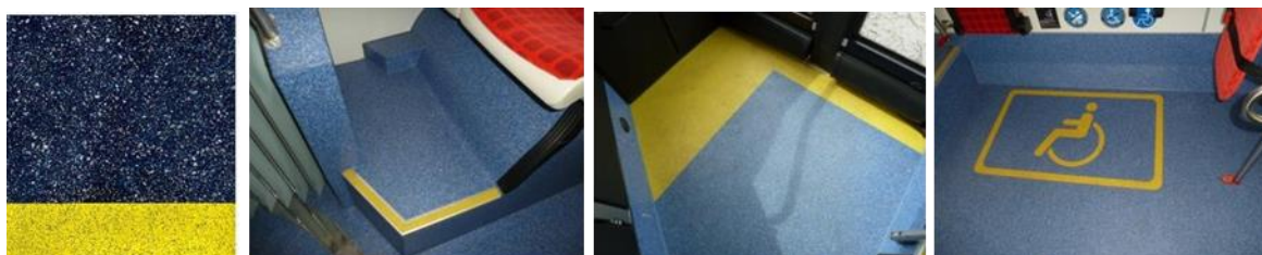
Figura 8.- Señalización esquinas y escalones
